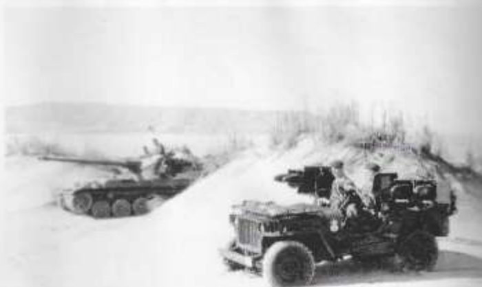
▲ Char léger AMX 13 et jeep équipé du système ENTAC lors d'un entraînement.
